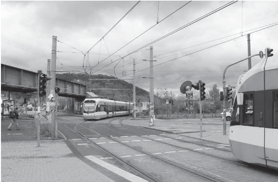
Römerkastellin järjestelmänvaihto rautatieltä (yllä sillalla) katuverkolle, Saarbrückenin duoraitiotie. Kuva: Mikko Laaksonen.
