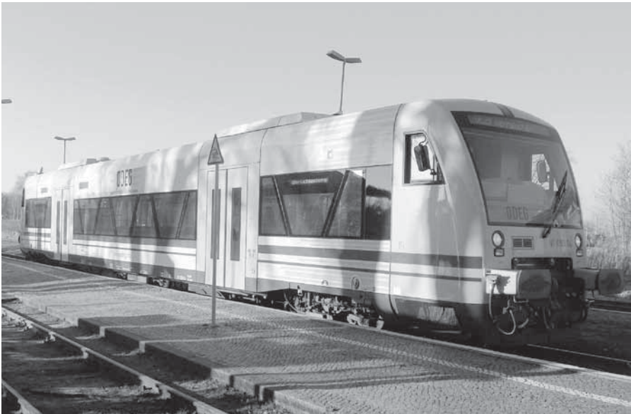
ODEG:n (Ostdeutsche Eisenbahn) Stadler RegioShuttle ajaa pikkukaupunkeihin, joiden väkimäärä vastaa esimerkiksi Hangon tai Äänekosken seutuja. Akselipaino on tyhjänä 10,5 tonnia, huippunopeus 120 km/h ja kiihtyvyys 1,2 \text{ m/s}^2 . Kuva Mikko Laaksonen.
